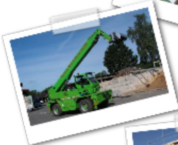
Die Anbaugeräte können innerhalb weniger Minuten angebracht bzw. gewechselt werden
